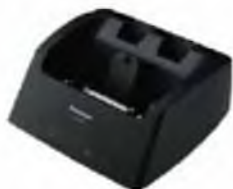
CF-VEBU11AU – настольная док-станция с возможностью зарядки двух дополнительных батарей
